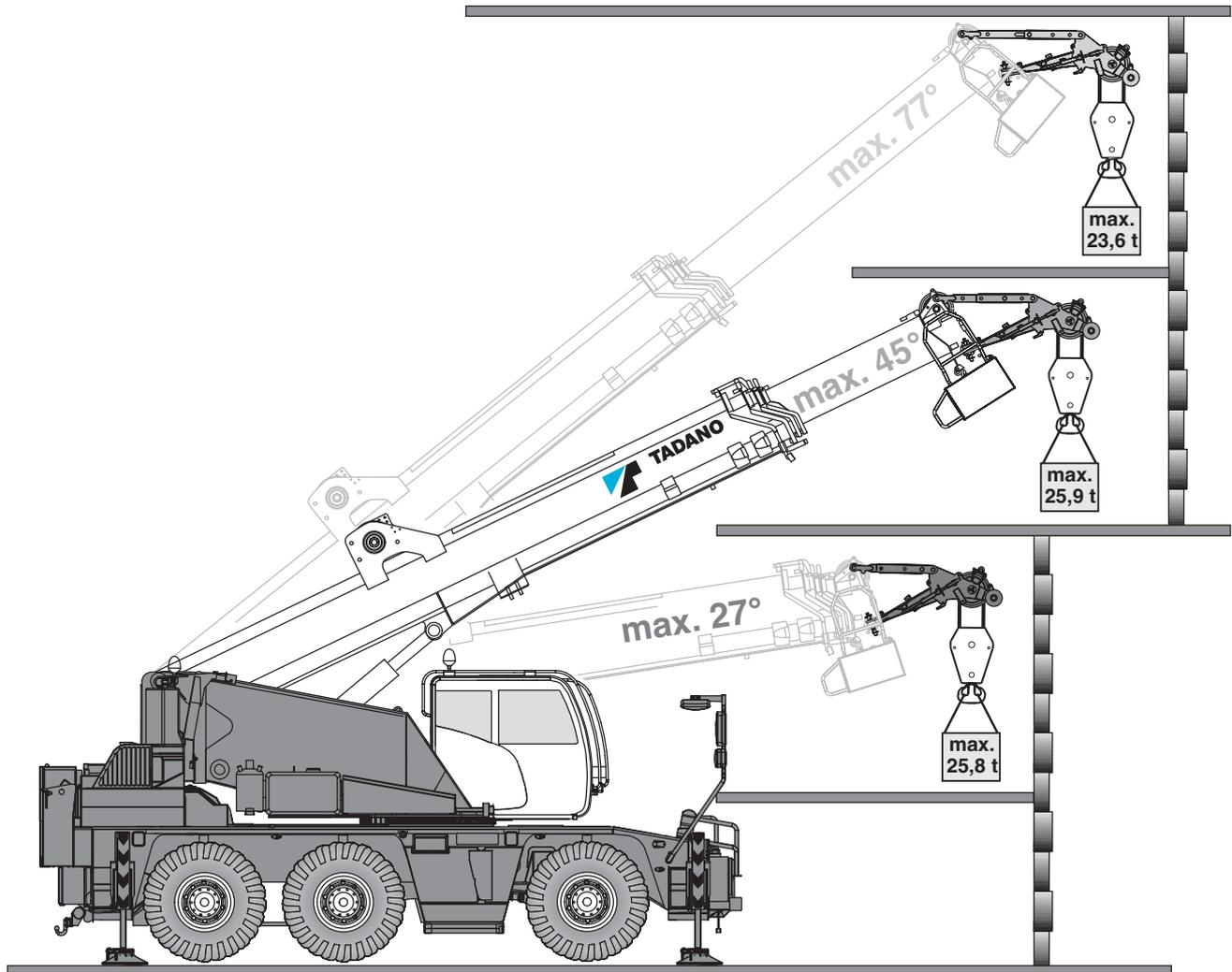
Hook traverse · Hakentraverse · Palonnier à crochet · Traversa del gancio · Travesa de gancho · Traversa de gancho · Траверса крюка
